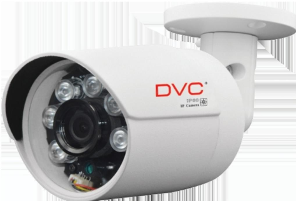
**AHD 1.0 vanjska kompaktna dan/noć IR kamera, 1/3" Aptina CMOS, 2.8mm fiksni objektiv, rezolucija 960p, osjetljivost 0 Lux IR ON (0.02 Lux IR OFF), 6 IR LED dometa 30-40m, D-WDR, napajanje 12VDC, potrošnja 60mA/340mA (IR ON), IP66**
