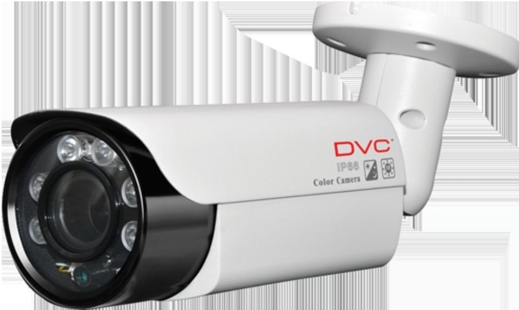
**AHD 2.0 vanjska kompaktna dan/noć IR kamera, 1/2.8" Sony EXMOR CMOS, 2.8-12mm varifokal objektiv, rezolucija 1080p, osjetljivost 0 Lux IR ON (0.017Lux IR OFF), 6 IR LED 3 generacije dometa do 25-35m, D-WDR, napajanje 12VDC, IP66.**
