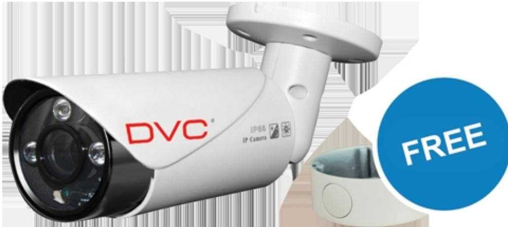
**AHD 1.0 vanjska kompaktna dan/noć IR kamera, 1/3" Sony EXMOR CMOS, 2.8-12mm varifokal objektiv, rezolucija 960p, osjetljivost 0 Lux IR ON (0.005 Lux IR OFF), 3 IR LED 3 generacije dometa do 50-60m, D-WDR, napajanje 12VDC, potrošnja 5WA, IP66.**
